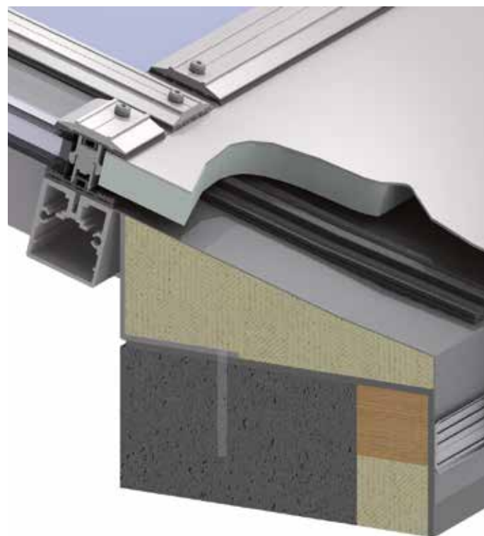
Montaggio su cordolo in cemento
